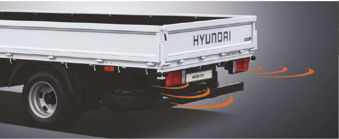
Звуковой сигнал при движении задним ходом Позволяет безопасно маневрировать при движении назад.
